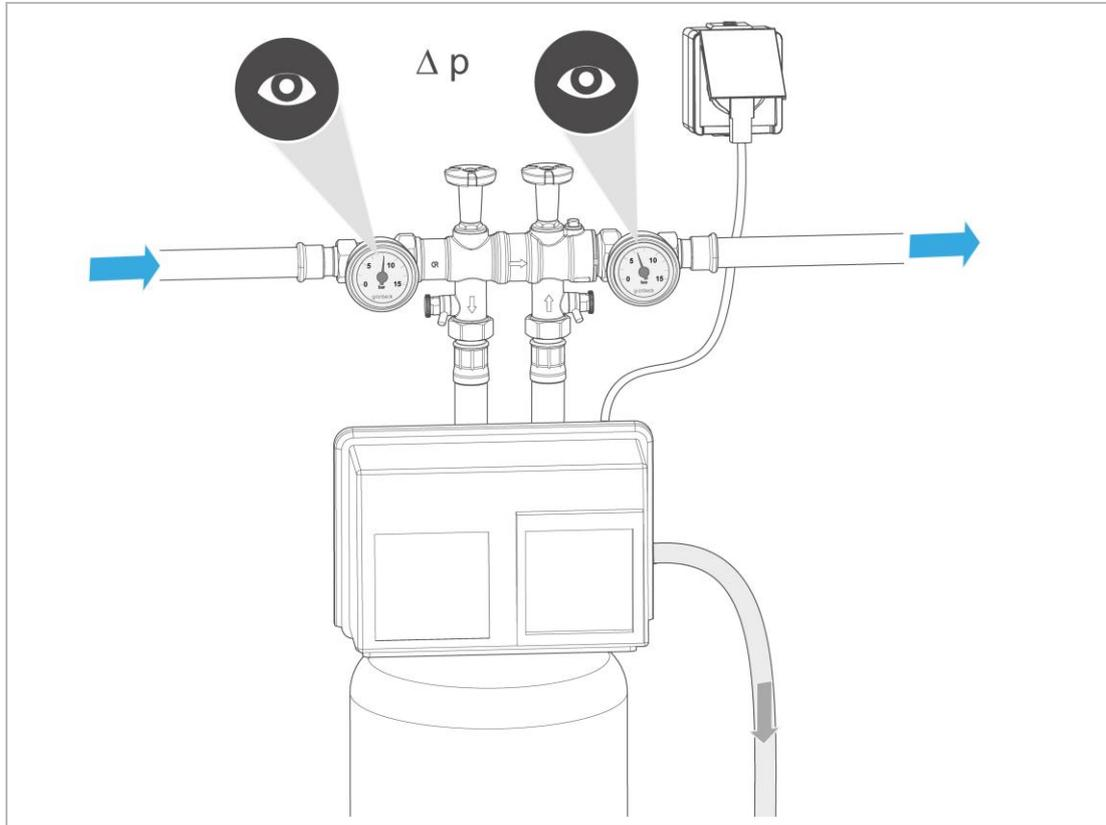
1. Prüfen Sie den Eingangsdruck am Manometer vor dem Produkt und den Ausgangsdruck am Manometer nach dem Produkt.
