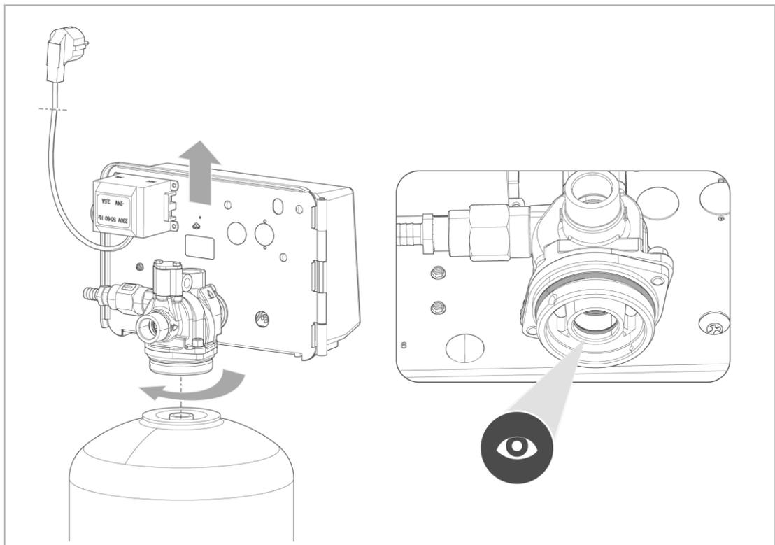
6. Schrauben Sie das Steuerventil ab.
