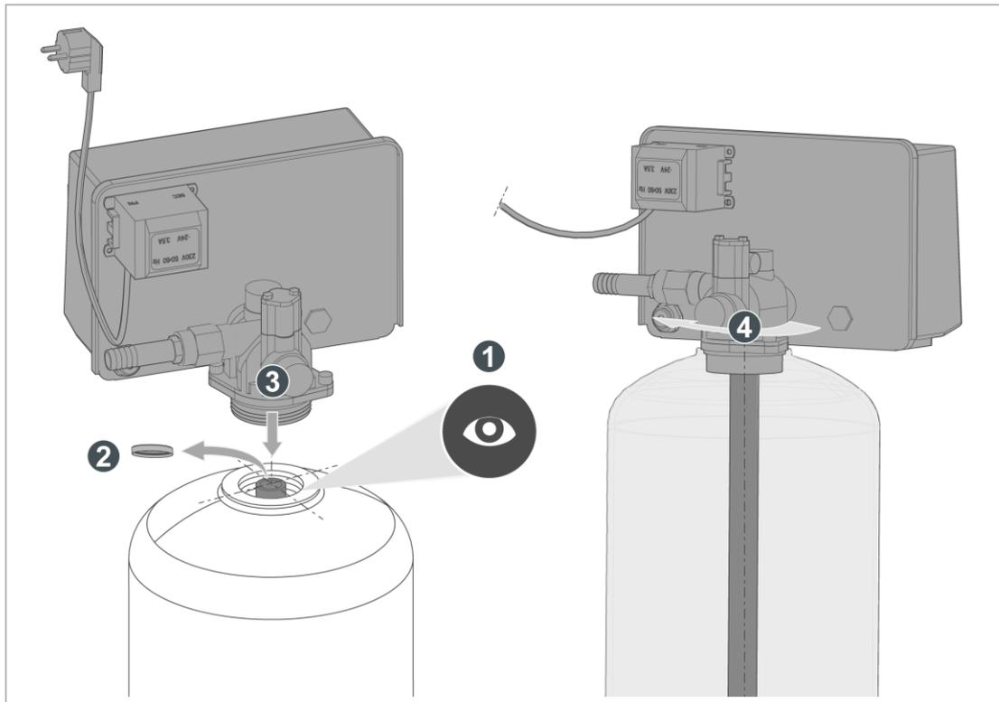
1. Reinigen Sie an der Filterflasche das Gewinde und die Dichtfläche des Steuerventilanschlusses von evtl. anhaftendem Filtermaterial.
