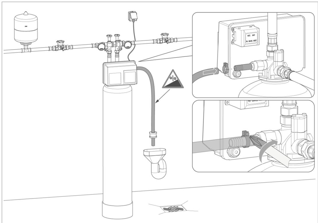
1. Fixieren Sie den Spülwasserschlauch mit der Schelle am Anschluss des Steuerventils.
