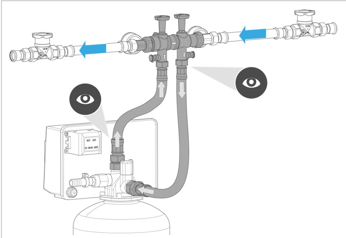
Enteisungs-/Entmanganungsanlage DN 40 mit Anschluss-Set 1½"
