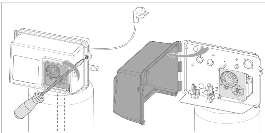
1. Lösen Sie die Schraube an der Gehäuseabdeckung.
