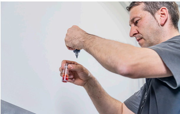
Ein SHK-Handwerker stellte bei den Familien Link und Lang jeweils eine Wasserhärte von 21 °dH fest. Ein Härtegrad, bei dem dringend eine Enthärtungsanlage empfohlen wird. Bild: Grünbeck Wasseraufbereitung GmbH
