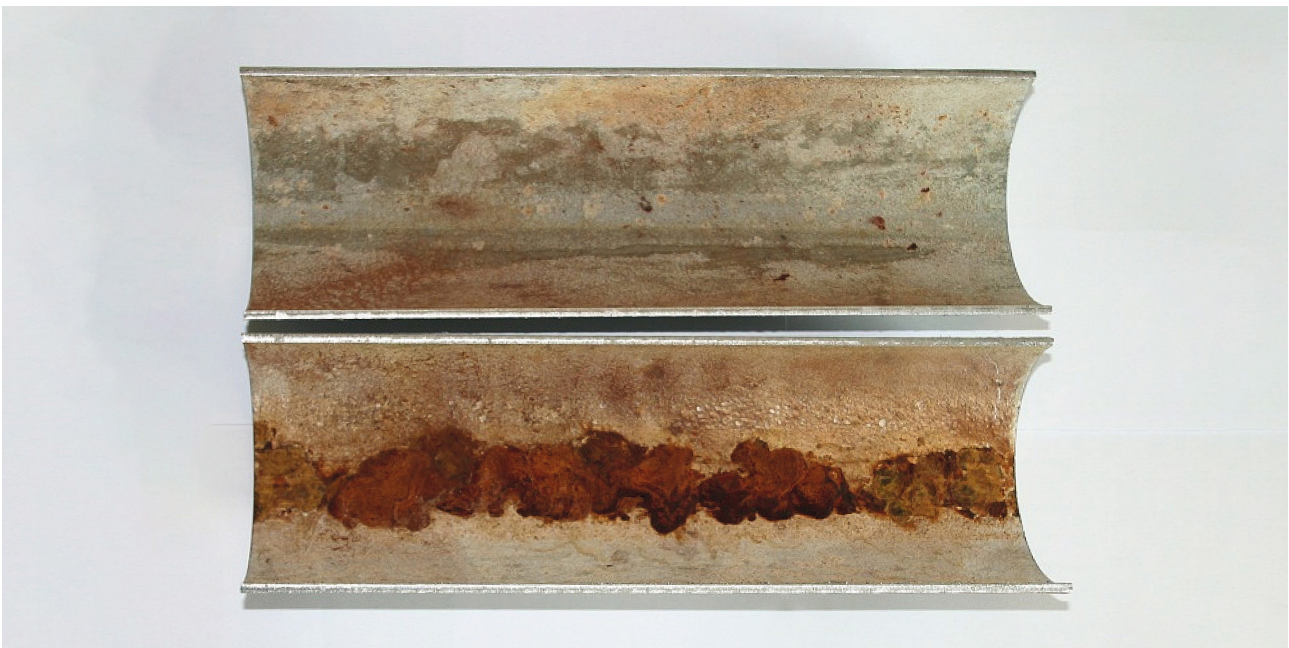
Abbildung 3: Partikelinduzierte Lockkorrosion in 6-Uhr-Lage.
